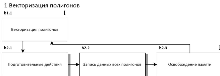
Рис. 1 – Диаграмма декомпозиции векторизации полигонов на снимке БПЛА
