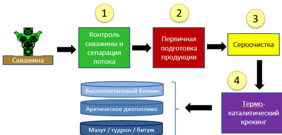
Рис. 1 — Ключ к решению проблемы развития северных территорий – создание сети модульных систем производства ГСМ на малых и удаленных месторождениях
