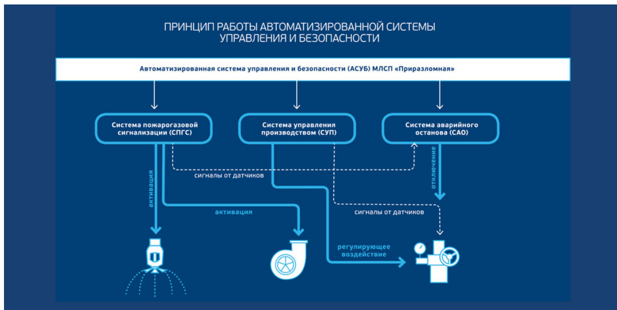
Рисунок 1 – Принцип работы автоматизированной системы управления и безопасности
