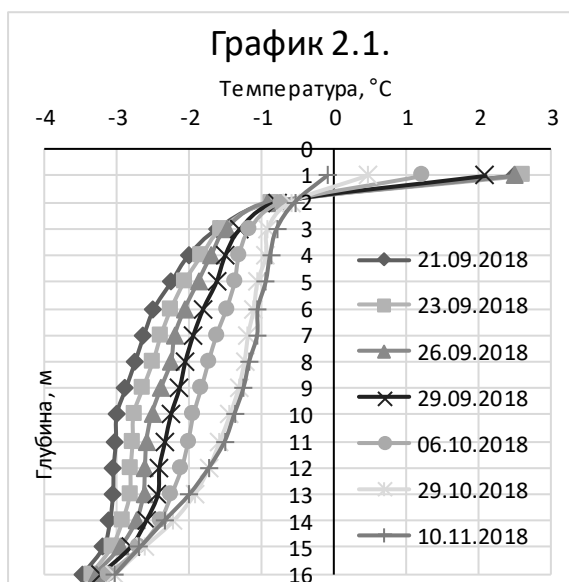
График 2.1. и 2.2. Графики изменения температур грунтов в температурной трубке (график 2.1.) и сваи (график 2.2.) на ростверке из 4 свай расположенного в середине здания.
