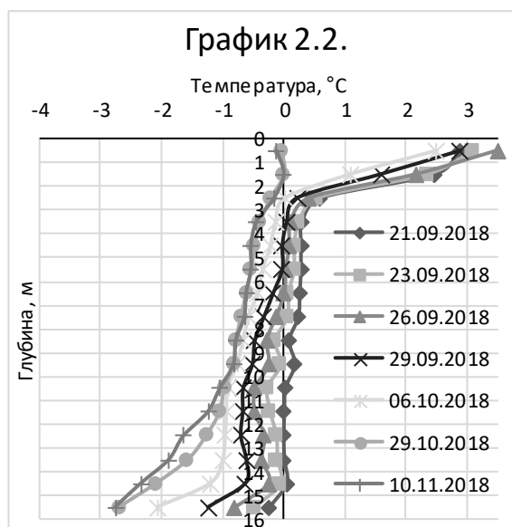
График 2.1. и 2.2. Графики изменения температур грунтов в температурной трубке (график 2.1.) и сваи (график 2.2.) на ростверке из 4 свай расположенного в середине здания.
