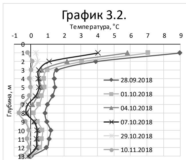
График 3.1. и 3.2. Графики изменения температур грунтов в температурной трубке (график 3.1.) и сваи (график 3.2.) на ростверке из 16 свай расположенного в середине здания.
